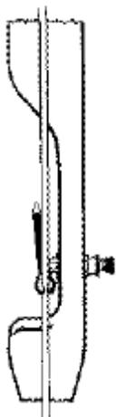
Guardate la figura. Regolate il bottone fino a quando il lato destro della punta sia in linea con il lato sinistro della corda. Non fate riferimento alla punta della freccia ma alla parte terminale dell'asta. Tirate a 18 metri **SENZA REGOLARE IL MIRINO**. Correggete il volo della freccia regolando la tensione della molla del bottone. Tirate tutte le frecce sulla stessa visuale e cercate di raggruppare.
